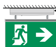
Τοποθέτηση στην οροφή
